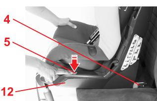
❖ Вставьте оба консольных фиксатора **4** в приемные приспособления **1**, чтобы фиксаторы зашли в зацепление с **обеих сторон**. "ЩЕЛК!"
